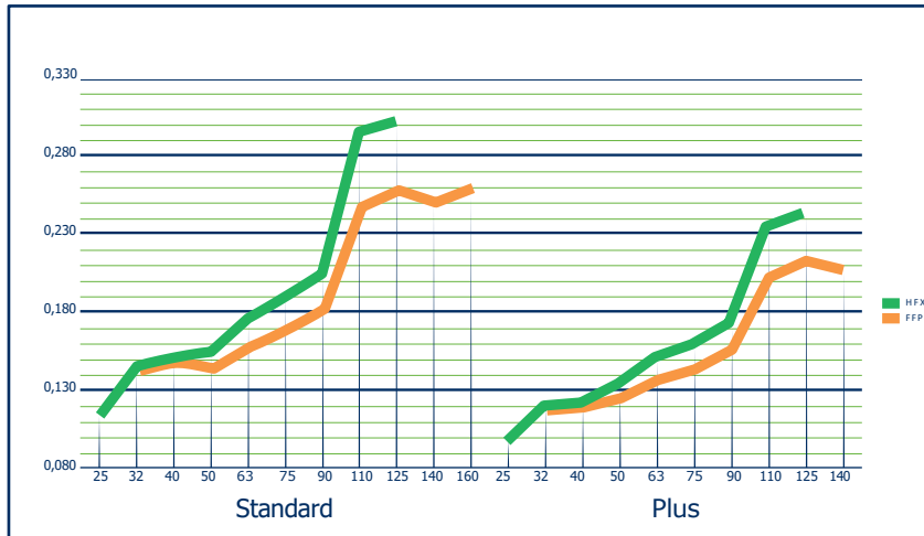
Порівняння показника U [Вт/мК] Heatflex vs. FibreFlex Pro труби
